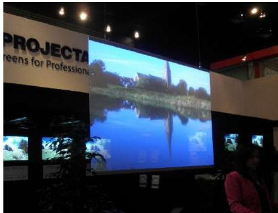
Pantalla de retroproyección holográfica en base acrílica especialmente indicada para la proyección en puntos de venta en tiendas, escaparates, bancos y otras áreas de tránsito elevado. Si no se está proyectando permite ver a través. Requiere una intensidad de luz controlada. La pantalla queda en suspensión gracias a un marco inferior y superior para colgar de cables de acero. Requiere una proyección en un ángulo entre 18-35 grados.
